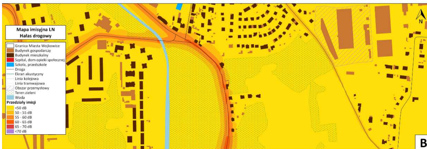
Rysunek 13 Sytuacja przed (A) i po (B) zastosowaniu proponowanych działań ograniczających emisję hałasu do środowiska, Zad. 6 - Ul. Katowicka (ok. 400 m na południe od ul. Reymonta), Czeladź – wskaźnik L_N .
