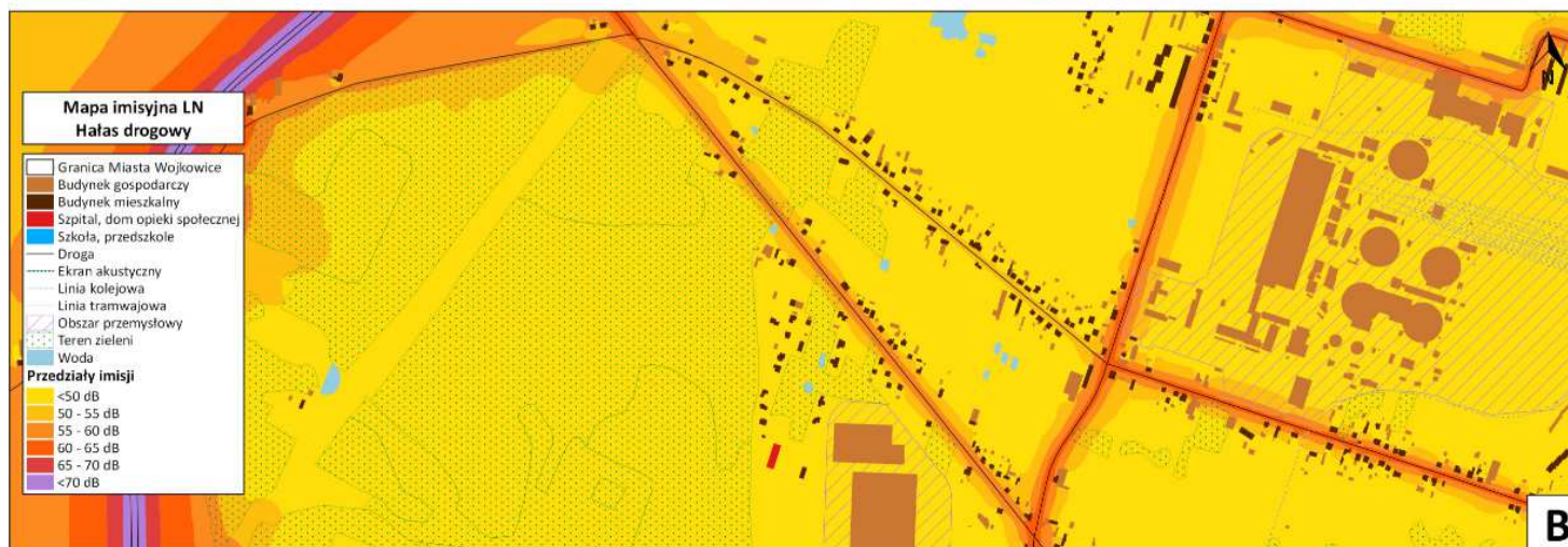
Rysunek 15 Sytuacja przed (A) i po (B) zastosowaniu proponowanych działań ograniczających emisję hałasu do środowiska, Zad. 7 - Rejon skrzyżowania ul. Gzichowska ul. Odkrywkowa (do rejonu skrzyżowania z ul. Mickiewicza), Będzin – wskaźnik L_N .
