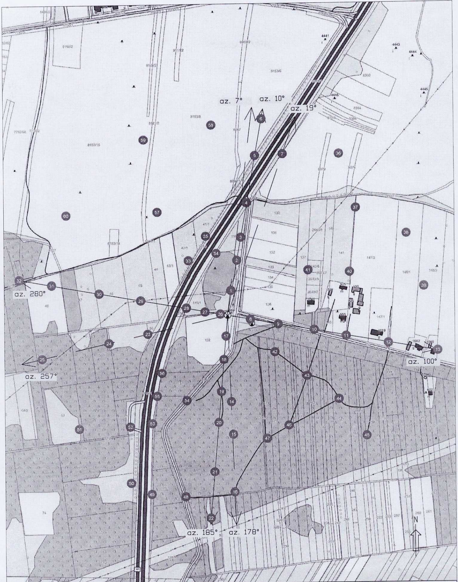
Rys.1 Lokalizacja pionów pomiarowych
